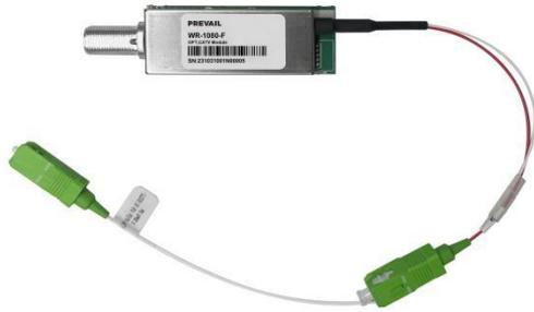
WR-1080-F 是专为 FTTH 网络的 ONU 端设计的，可接收 1555nm 波长，环出 1310nm、1490nm、1577nm 等波长。该接收模组集成了 WDM 和模拟 PIN 光电二极管。它可以与 GPON (Gigabit Passive Optical Net) 或 XG(S)-PON (10Gigabit Passive Optical Net) 收发器一起使用，以实现 FTTH 网络的三重播放功能。
