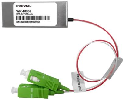
WR-1080-I 是专为 FTTH 网络的 ONU 端设计的,可接收 1555nm 波长, 环出 1310nm、1490nm、1577nm 波长 (单纤三波)。该接收模组集成了 WDM 和模拟 PIN 光电二极管。它可以与 GPON (Gigabit Passive Optical Net) 或 XG(S)-PON (10Gigabit Passive Optical Net) 收发器一起使用, 以实现 FTTH 网络的三重播放功能。
